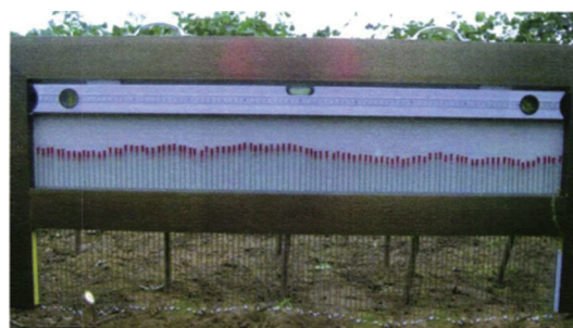
图3 针板法测量示意图
